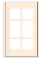
**Richtung der Maserung:** bis zur Höhe 319 mm (inkl.) - horizontal, auf Wunsch kann die Richtung der Maserung geändert werden.
